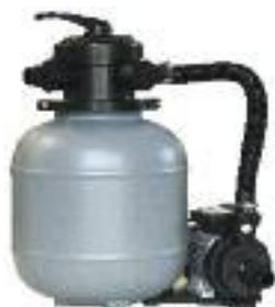
Kunststoffkessel Ø 330 mm, mit 4-Wege-Top-Mount-Ventil. Pumpenleistung 4,0 m<sup>3</sup>/h. Pumpe 0,20 kW. Kleine Filterpalette. Ohne Vorfilter (kann aber nachgerüstet werden). Sandfüllmenge 20 kg. Geeignet für Schwimmbecken bis 27 m<sup>3</sup> Beckeninhalt.
