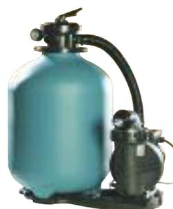
Kunststoffkessel Ø 450 mm mit 6-Wege-Top-Mount-Ventil, Palette und Manometer. Pumpe 0,65 kW (P1), selbstansaugend, 10 m<sup>3</sup>/h Pumpenleistung. Sandfüllmenge 75 kg. Geeignet für Schwimmbecken bis max. 45 m<sup>3</sup> Beckeninhalt.
