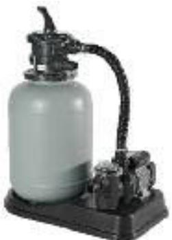
Kunststoffkessel Ø 330 mm, mit 6-Wege-Top-Mount-Ventil, Manometer. Pumpenleistung 6,0 m<sup>3</sup>/h. Pumpe 0,27 kW, selbstansaugend, inkl. Vorfilter. Sandfüllmenge 20 kg. Geeignet für Schwimmbecken bis 30 m<sup>3</sup> Beckeninhalt.
