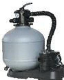
Kunststoffkessel Ø 390 mm, mit 6-Wege-Top-Mount-Ventil, Manometer. Pumpenleistung 7,0 m<sup>3</sup>/h. Pumpe 0,65 kW, selbstansaugend, inkl. Vorfilter. Sandfüllmenge 30 kg. Geeignet für Schwimmbecken bis 35 m<sup>3</sup> Beckeninhalt.
