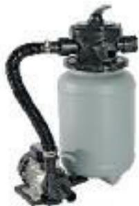
Kunststoffkessel Ø 250 mm, inkl. kleiner Filterpalette, mit 4-Wege-Top-Mount-Ventil. Pumpenleistung 3,5 m<sup>3</sup>/h. Sandfüllmenge 15 kg. Anschluss für 32 mm Schwimmbad-schlauch. Ohne Vorfilter (kann aber nachgerüstet werden). Geeignet für Schwimmbecken bis 25 m<sup>3</sup> Beckeninhalt.
